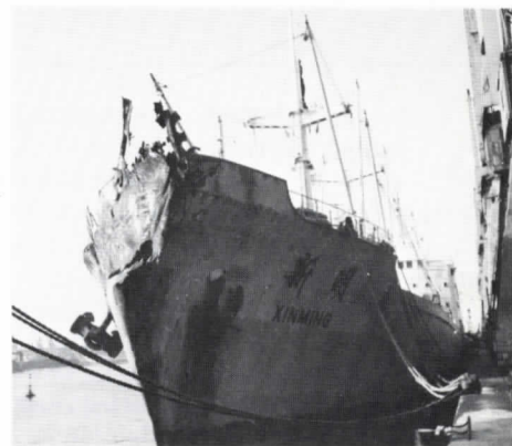
Winter Moons bordläggning fick kraftiga intryckningar medan Xinming fick omfattande skador på backen.
