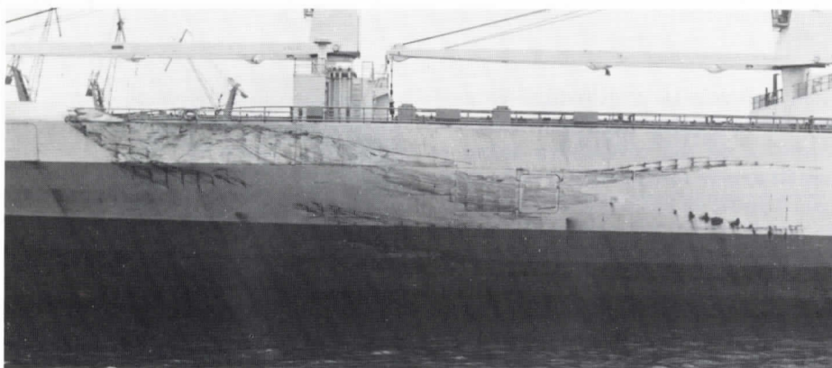
Winter Moons bordläggning fick kraftiga intryckningar medan Xinming fick omfattande skador på backen.
