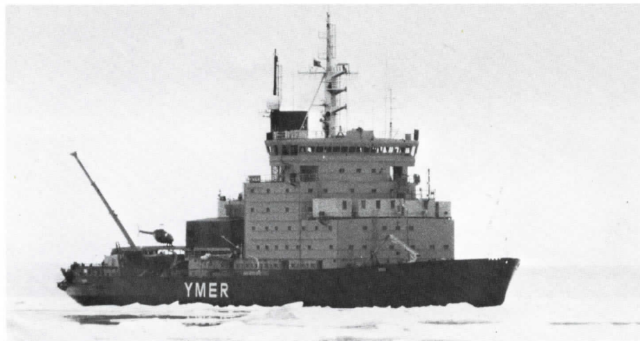
Ymer, som polarutrustades på Finnboda varv, är egentligen en östersjöisbrytare men klarade sig ändå förvånansvärt bra i den grova polarisen. Till skillnad från andra polarisbrytare har Ymer två propellrar förut och två akterut. Fartyget drivs av ett dieselelektriskt maskineri på 22.000 hkr.
