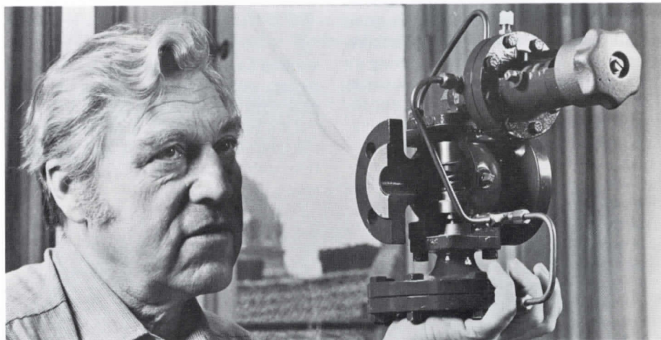
Alvar Svensson, teknisk chef, visar en självverkande reglerventil av egen konstruktion. Ventilen är extremt energisnål och behöver ingen hjälpenergi.
