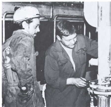
1:e maskinist Leif Henningsson och motorman Stig Larsson skiftar smörjoljekylare på en hjälpmotor.
