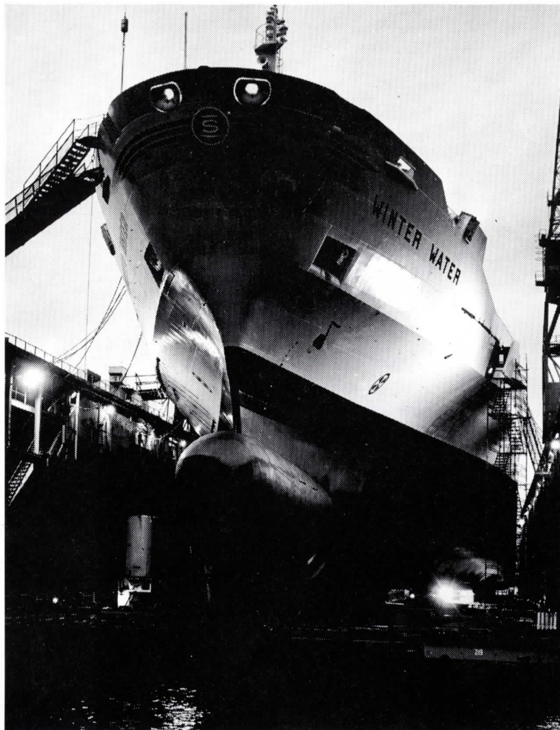
Winter Water indockad på Cityvarvet för komplettering och reparation efter brand i 1:ans lastrum.
