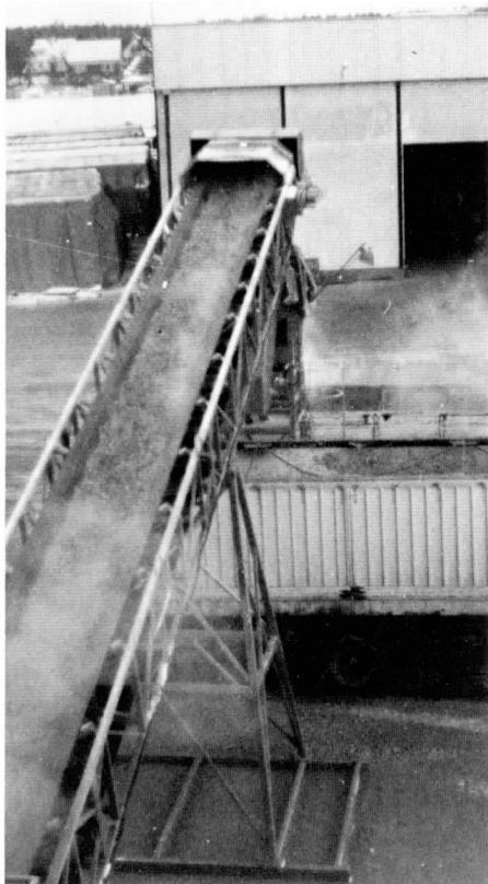
Från fartygets hoppers transporteras flisen långskepps på däck till förskeppet, där den med hjälp av conveyorband tvärskepps förs iland. I Raumo omlastades flisen direkt till stora flisfordon.
