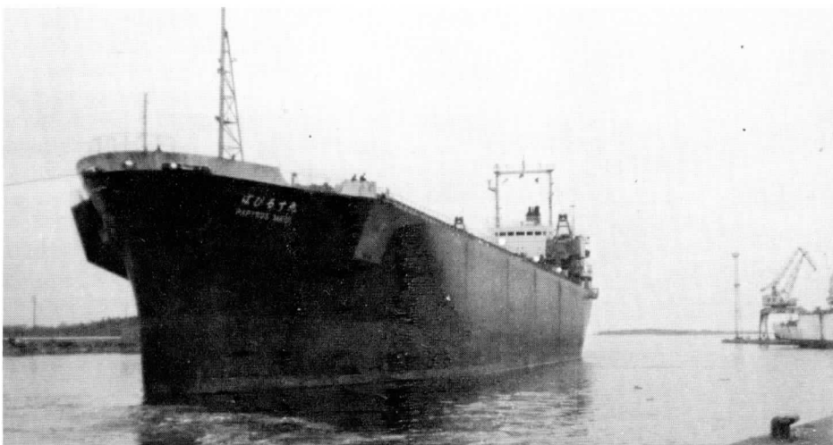
Från fartygets hoppers transporteras flisen långskepps på däck till förskeppet, där den med hjälp av conveyorband tvärskepps förs iland. I Raumo omlastades flisen direkt till stora flisfordon.
