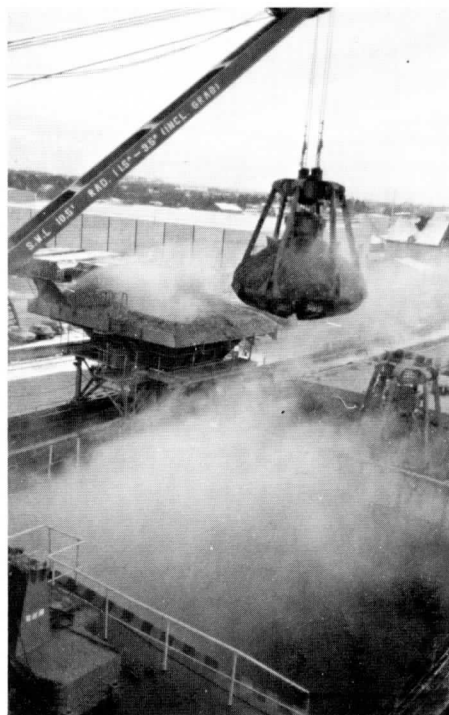
Flisen lossas till hoppers med en av fartygets två skopor. Varje lyft tar 10 kubikmeter.
