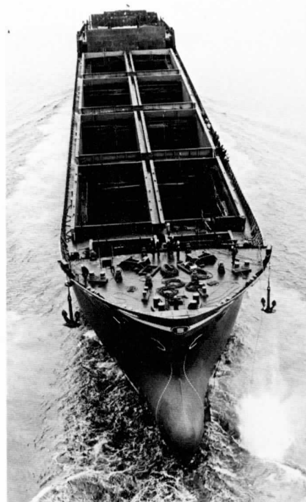
Varvet i Wismar tillämpar fortfarande stapelavlöpningar på gammalt vis. Här har Delphic Wasa just glidit från bädden ut i sitt rätta element.
