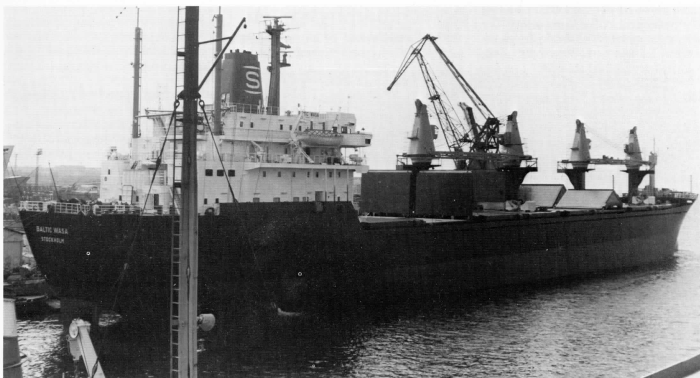
Baltic Wasa klar för leverans. Som synes är däckshuset en våning lägre än i systerfartyget Arctic Wasa.
