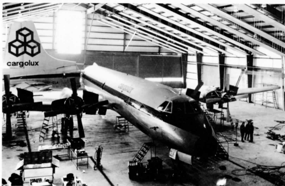
Cargolux bygger för närvarande en ny hangar vid Luxembourg Airport avsedd för företagets flotta av CL-44:or och DC-8:or. Nyligen körde den första maskinen, en CL-44, in i hangaren för periodisk inspektion. På bilden ses planet med öppen swingtail.
