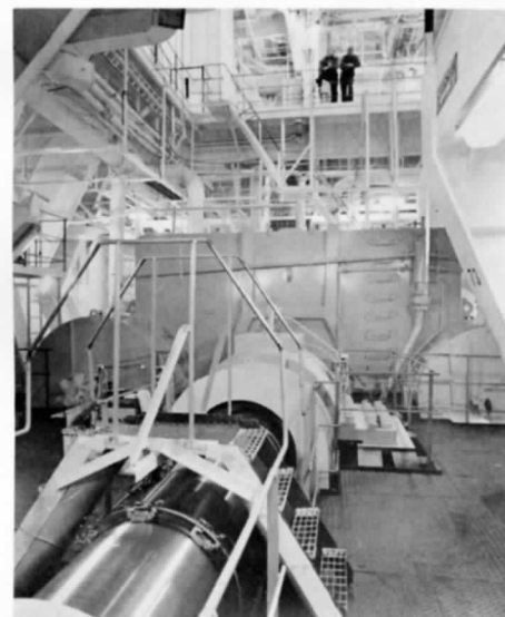
Längst ner på bilden ser man propelleraxeln och uppe till höger maskinkontrollrummet.
