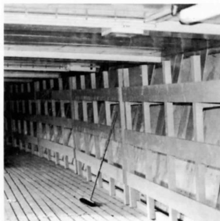
Pallskott av den nya halvpermanenta typen. När lasten inte är pallad, sätts pallskotten upp mot fartygsskotten.
