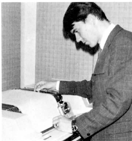
Dataterminalen består av radskrivare, kortläsare och bildskärm. Bilden visar Lasse Lönnberg vid radskrivaren.
