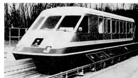
Aerotraintåg på provbanan utanför Paris.
